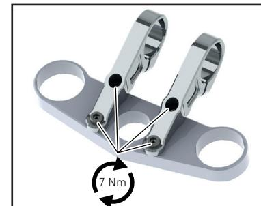
**Schritt 5:** Ziehen Sie nun die vier M6-Schrauben, die den Vorbaus auf der oberen Brücke halten, mit einem Drehmoment von 7 Nm über Kreuz fest.
