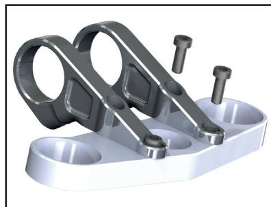
**Etape 3:** Mettez les 2 parties de la potence sur le té supérieur de la fourche. Serrez les vis M6 seulement légèrement pour le moment – en vous assurant de bien positionner les 2 parties dans le bon sens (le bas sur le haut de la fourche).
