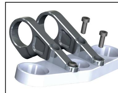
**Schritt 3:** Montieren Sie die beiden Vorbauhälften auf der oberen Gabelbrücke und ziehen Sie die M6-Schrauben handfest an - so, dass diese anliegen, jedoch noch in den Durchgangslöchern der Befestigungsschrauben ausrichtbar sind.
