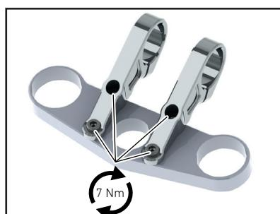
**Etape 5:** Maintenant serrez les 2 parties de la potence sur le té supérieur de la fourche avec les 4 vis M6 en les serrant chacunes jusqu'à 7 Nm.
