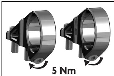
**Etape 4:** Tout en vérifiant que votre potence n'est pas en torsion – positionnez votre cintre dans la position désirée (angle) en le maintenant centré et serrez les 2 vis jusqu'à **5 Nm**.
