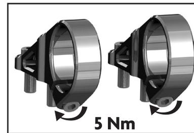
**Schritt 4:** Vergewissern Sie sich, dass der Aufbau nicht unter Spannung steht – nun richten Sie Ihren Lenker in der gewünschten Position / im gewünschten Winkel aus und ziehen Sie die M5-Schrauben der Lenkerklemmung mit einem Drehmoment von **5Nm** fest:
