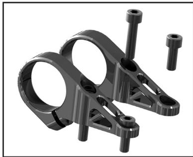
**Etape 3:** Mettez les 2 parties de la potence sur le té supérieur de la fourche. Serrez les vis M6 seulement légèrement pour le moment – en vous assurant de bien positionner les 2 parties dans le bon sens (le bas sur le haut de la fourche). ATTENTION il y a 2 types de vis M6 différents à utiliser, les + longues (M6x25) devant être utilisées pour les trous de fixation AVANT, et les 2 + petites (M6x16) pour les fixations ARRIERES suivant le schéma.
