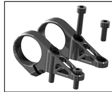
**Schritt 3:** Montieren Sie die beiden Vorbauhälften auf der oberen Gabelbrücke und ziehen Sie die M6-Schrauben handfest an, so, dass diese anliegen, jedoch noch in den Durchgangslöchern der Befestigungsschrauben ausrichtbar sind. 2 verschiedene Schraubenlängen kommen zum Einsatz: Die Längeren (M6x25) werden in den vorderen beiden Durchgangslöchern, welche näher am Lenker stehen, verwendet, die Kürzeren (M6x16) werden in den hinteren Löchern wie abgebildet verwendet:
